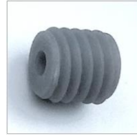
Kunststoff – Drosselschraube Gewindedüse M6x6 Typ 060 P-ø2,5 mm
